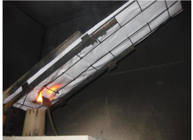
Dependiendo del comportamiento que muestre el material durante el ensayo principal, aplican dos ensayos complementarios que evalúan el goteo del material y la persistencia de llama en materiales que funden y agujerean rápidamente. En caso de materiales inorgánicos, aplica otro ensayo que estudia la incombustibilidad del material
