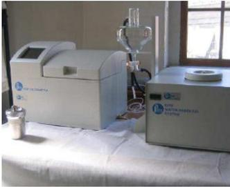
Este ensayo determina la máxima liberación total de calor potencial de un producto cuando se quema por completo, independientemente de su uso final.
